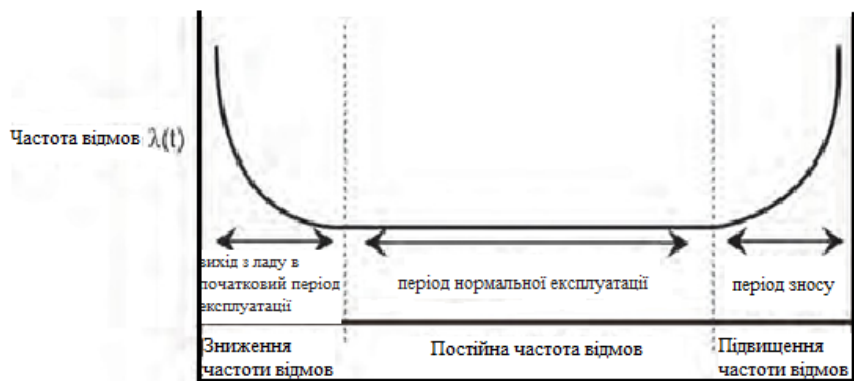
Малюнок 5.1.1. Інтенсивність частоти відмов з плином часу для номенклатури компонентів
